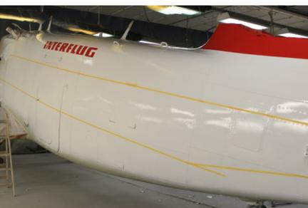
Mit Maskierband werden Details in der zukünftigen Bemalung der An-2 abgeklebt.
