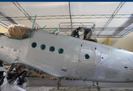
Nach dem Entfärben: Antennen und Kabinenfenster müssen abgeklebt werden.
